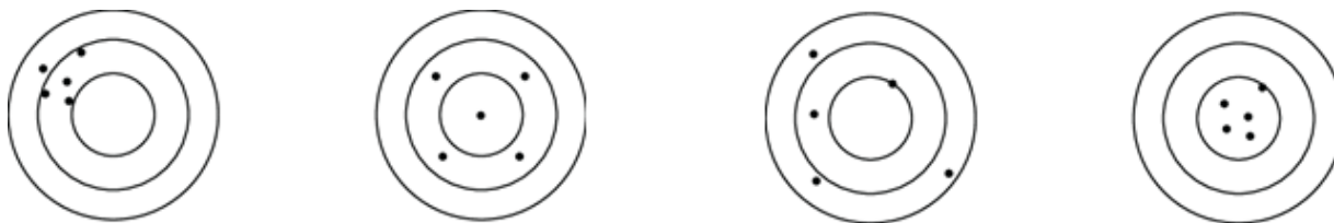
Slika 4. Dobra tačnost i loša preciznost, dobra preciznost i loša tačnost, loša preciznost i loša tačnost, i na kraju dobra preciznost i dobra tačnost
